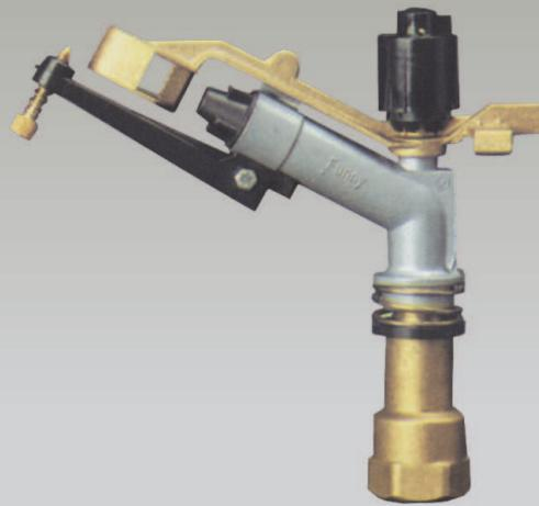
Irrigatore di piccola portata, per medie e basse pressioni, disponibile in due versioni, a giro completo e a settori di ampiezza variabile; è dotato di ugelli intercambiabili di un rompigetto regolabile che consente una fine dispersione del getto. È adatto per l'irrigazione di colture miste, ortaggi, fiori, frutteti, campi da gioco, e per la protezione antibrina.
