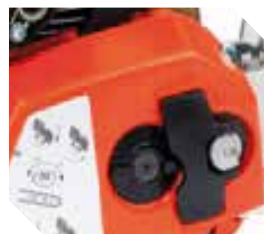
Tensor y apriete sin herramientas. solo modelo: PS32CTLC/35
