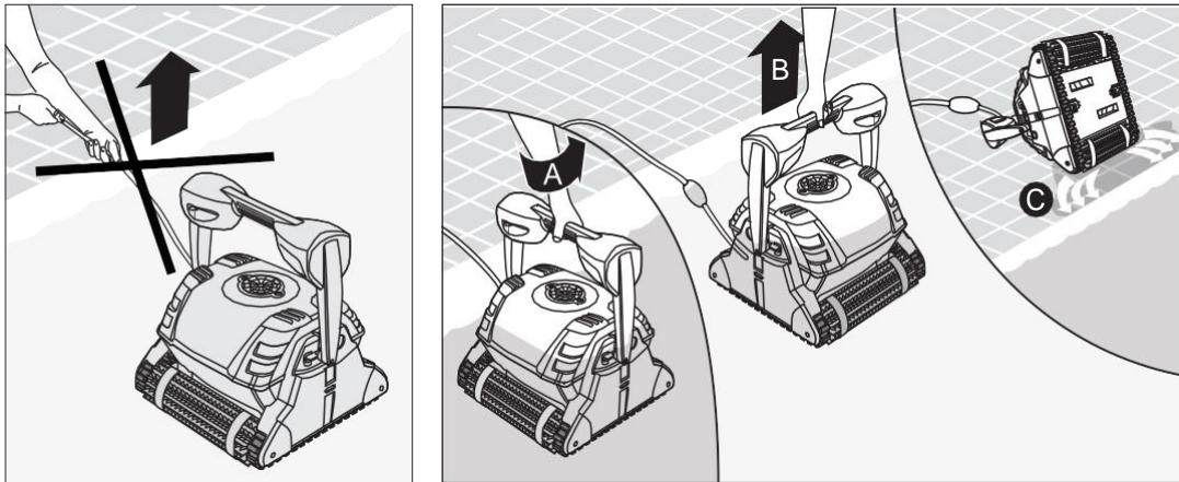
A l'aide du câble de flottaison, ramenez le nettoyeur de piscine au bord de la piscine.
