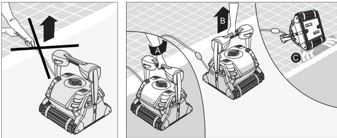
Utilizando o cabo flutuante, traga o aspirador até à borda da piscina.
