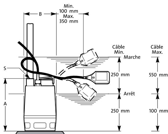
Profundidade de instalação: no máximo 10 m abaixo do nível da água.
