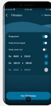
A filtração com temperatura controlada é executada com cálculo automático apresentado na aplicação
