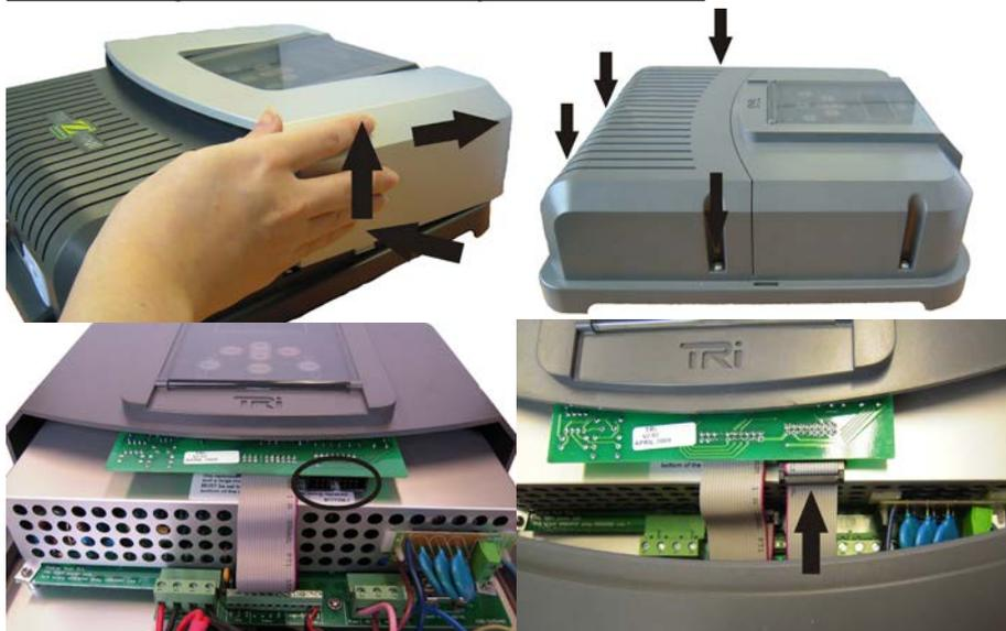
voltar a aparafusar os quatro parafusos e colocar a estrutura de protecção prateada.
