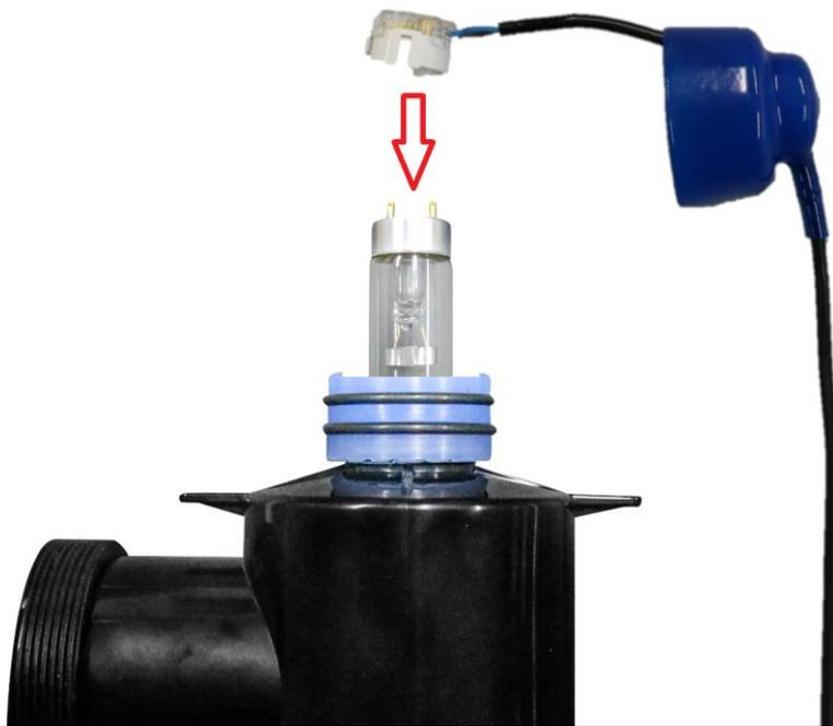
**NOTA:** *apriete el velo de sujeción azul de la lámpara cuando vuelva a montar la unidad para eliminar el aire atrapado. De no hacerlo, el aire atrapado puede provocar que la sujeción de la lámpara se desconecte de su extremo. Abra el suministro de agua para comprobar que no hay fugas **antes** de reconectar el suministro eléctrico.*
