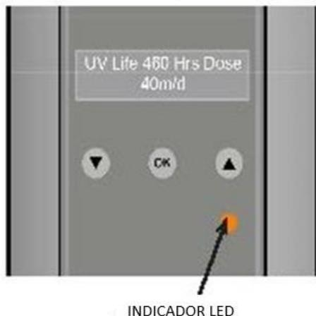
Siempre que la lámpara UV esté «Encendida», el temporizador va descontando horas a partir de 9000 y se muestra el tiempo de vida útil que le queda a la lámpara.
