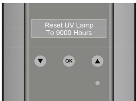
Cuando se reemplaza la lámpara UV por una nueva, el temporizador debe reiniciarse en 9000 horas. En el modo UV lamp life (vida útil de la lámpara UV), seleccione «Reset UV Lamp» (Reiniciar lámpara UV) manteniendo pulsado el botón OK. Inmediatamente, mantenga presionado el botón OK hasta ver en la pantalla «SAVED» (Guardado). Suelte el botón OK y verá en la pantalla «UV Life 9000 Hrs» (Vida útil de la UV 9000 hs). Un fallo en la alimentación no afecta este conteo de la vida de la lámpara.
