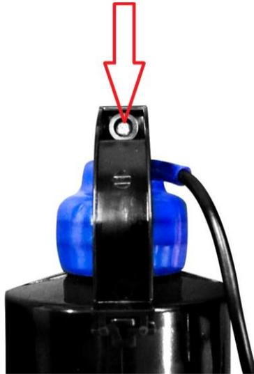
Con cuidado, retire el velo de sujeción azul de la lámpara y los toques eléctricos de plástico blanco del extremo de la lámpara.
