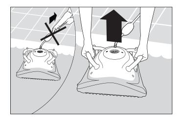
1 DO NOT PULL THE POOL CLEANER FROM THE POOL USING THE CABLE.
