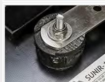
Au bas du panneau SUNIR-1a, insérez la pièce d'accouplement avec le cylindre, le cylindre étroit vers le panneau, insérez la plaque de support, et enfin la rondelle M5 plate large et l'écrou autobloquant. Serrez doucement jusqu'à ce que le panneau SUNIR-1a soit fixé et ne tourne pas. **NE FORCEZ PAS LE SERRAGE, L'ACCOPLEMENT POURRAIT CASER L'ADAPTATEUR !!**
