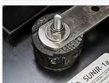
Por la parte inferior del panel SUNIR-1a, insertar la pieza de acople con el cilindro el cilindro estrecho hacia el panel, insertar la pletina de soporte, y finalmente la arandela M5 de ala ancha t la tuerca autoblocante.
