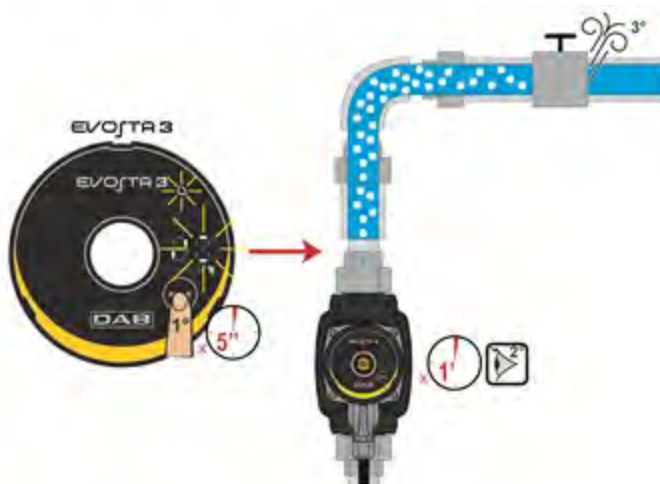
Obrázok 9: Automatické odvzdušnenie čerpadla
