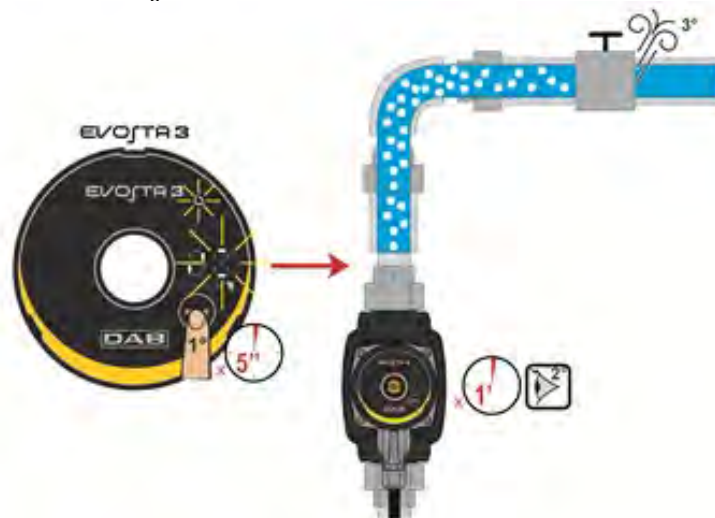
Fig 9: Automatisk avluftning av pumpen
