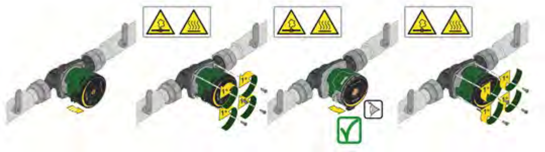
Abb. 6: Positionsänderung der Benutzerschnittstelle
