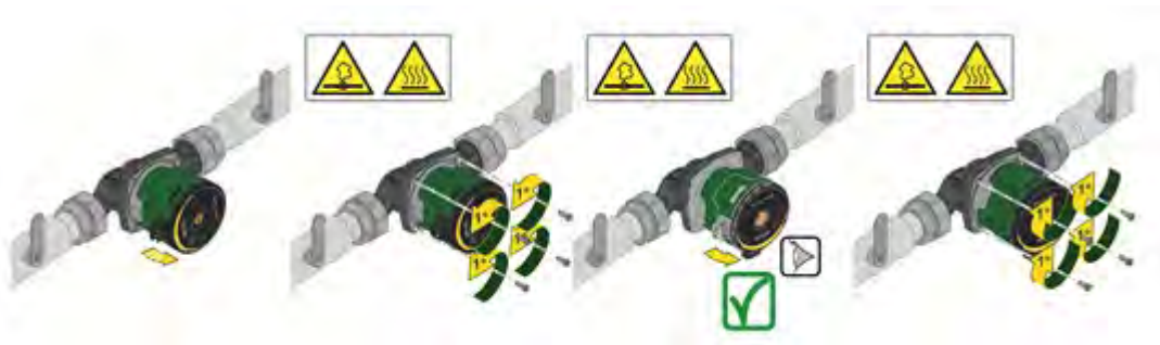
Figura 6: Cambio de la posición de la interfaz del usuario
