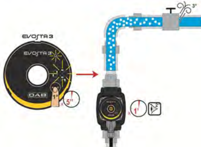
Joonis 9: Pumba automaatne õhutustamine
