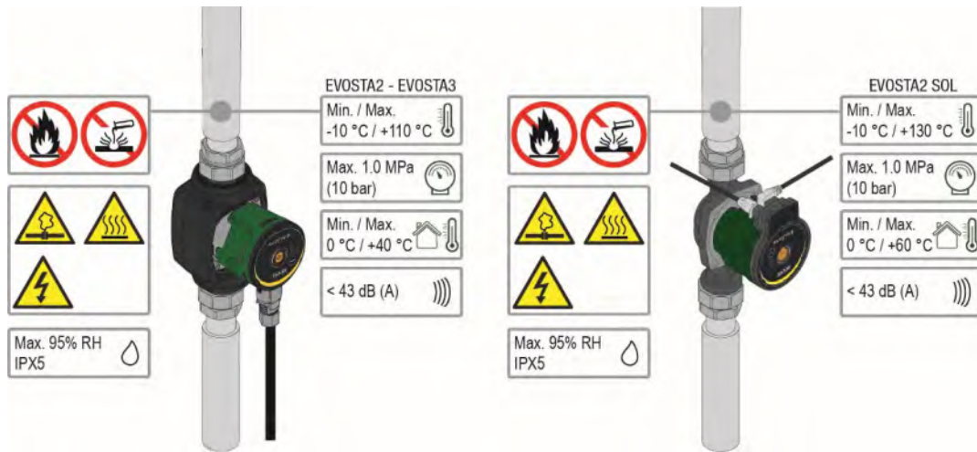
Kuva 1: Pumpattavat nesteet, varoitukset ja käyttöolosuhteet
