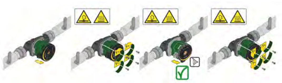
Fig 6: Ändring av användargränssnittets position
