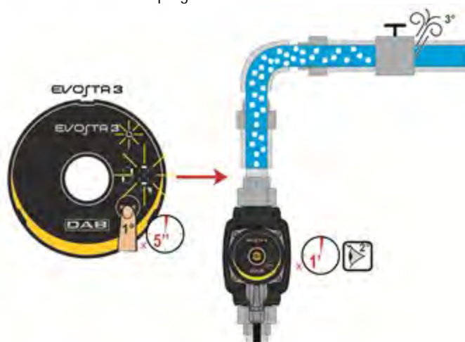
Figura 9: Drenagem automática da bomba
