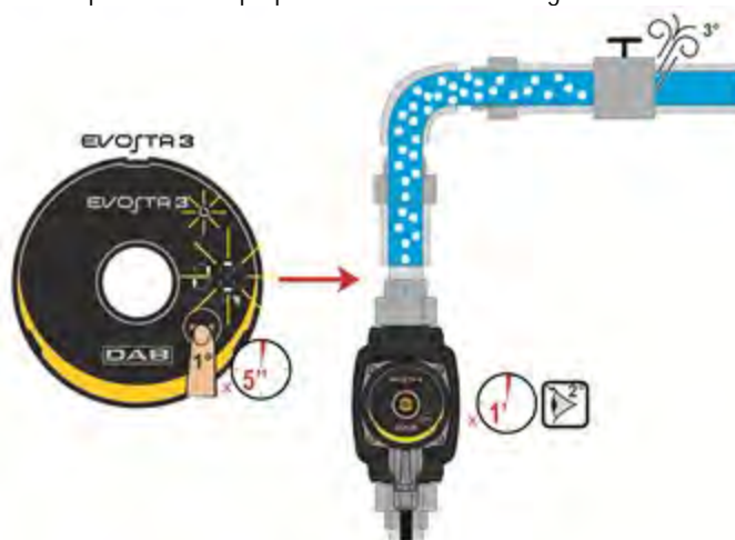
Figura 9: Purga automática de la bomba
