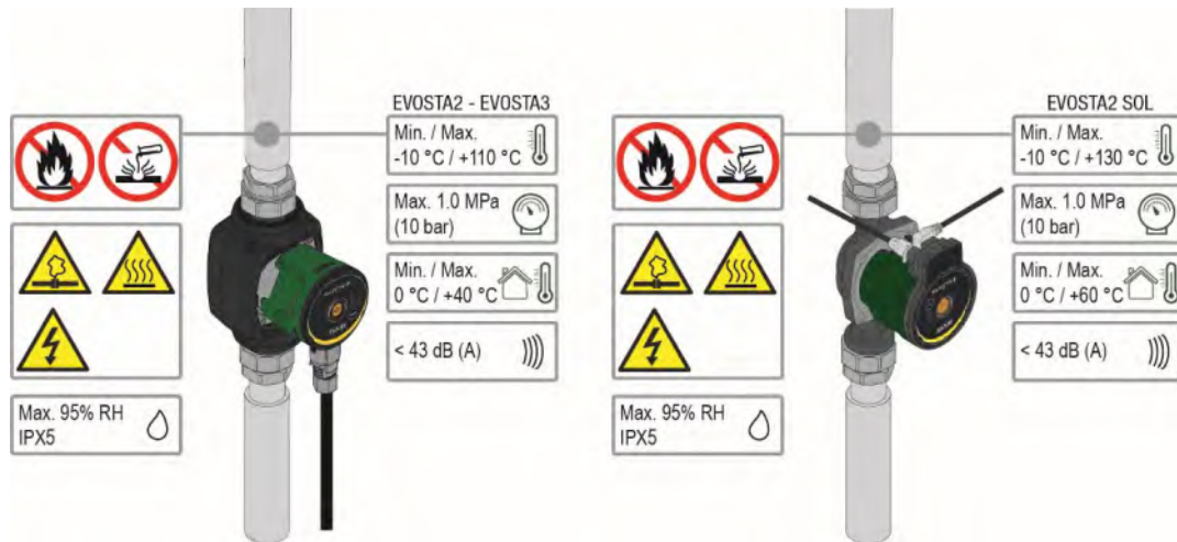
Figura 1: Liquidi pompati, avvisi e condizioni di funzionamento
