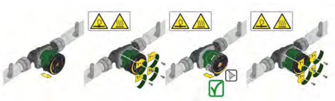
Figura 6: Troca de posição da interface utilizador
