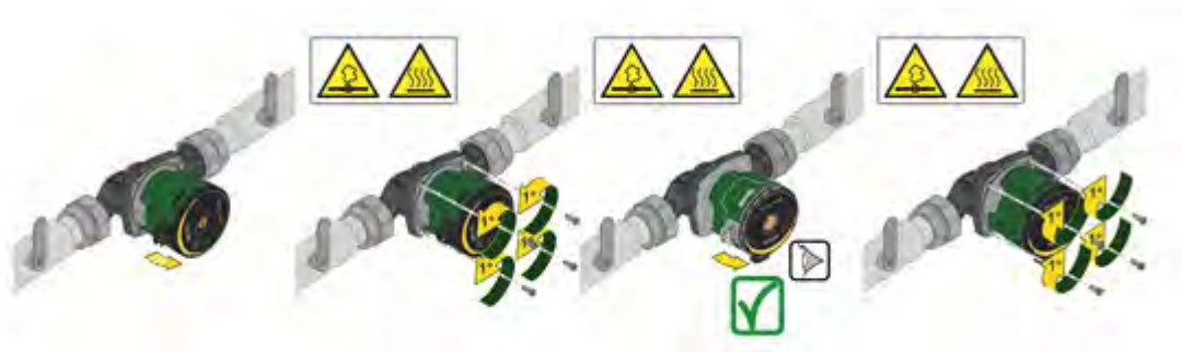
Afbeelding 6: Verandering van de positie van de gebruikersinterface
