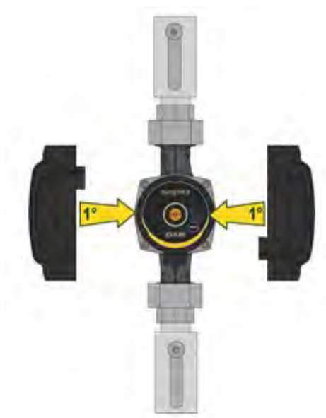
Figura 7: Aislamiento del cuerpo de la bomba
