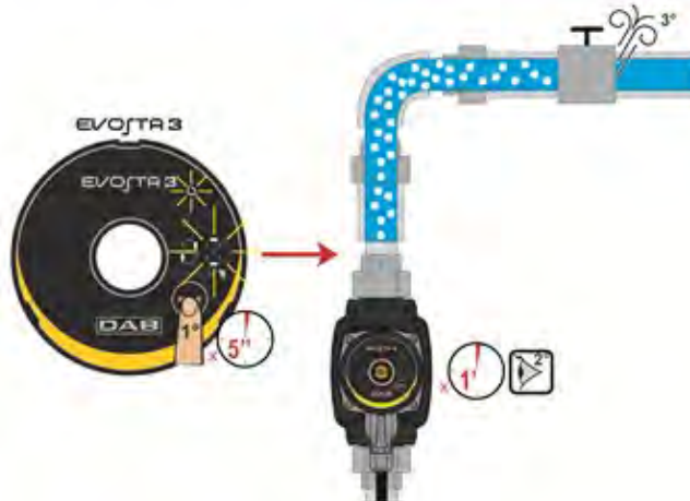
Image 9: Purge automatique de la pompe
