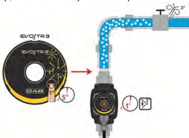
Slika 9: Avtomatska odzračitev črpalke
