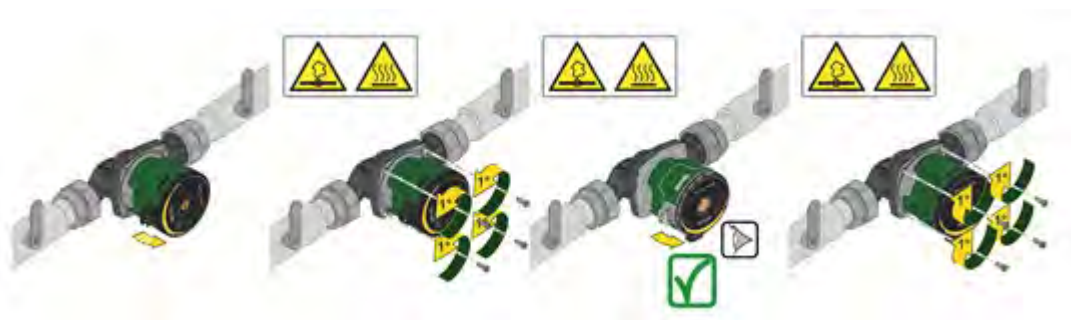
Figura 6: Modificarea poziției interfeței utilizator
