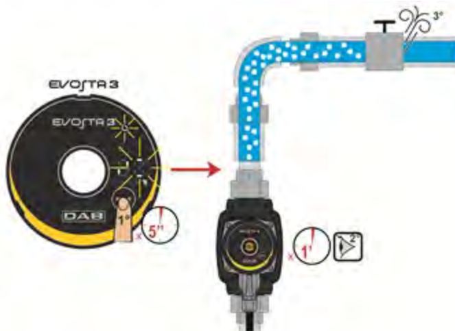
Attēls 9: Sūkņa automātiska gaisa izvadīšana
