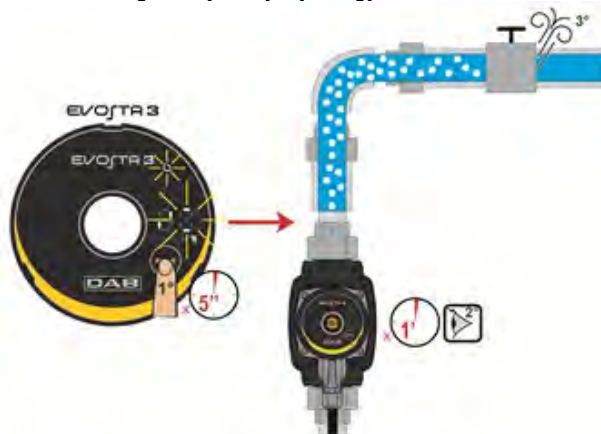
9. ábra: A pumpa automatikus légmentesítése
