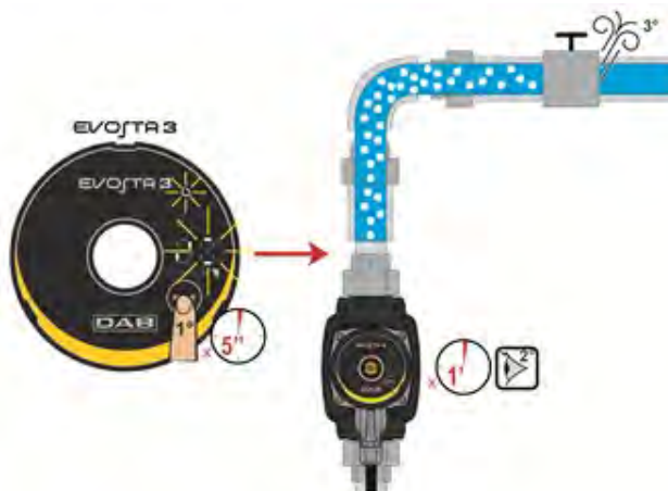
Figura 9: Aerisirea automată a pompei
