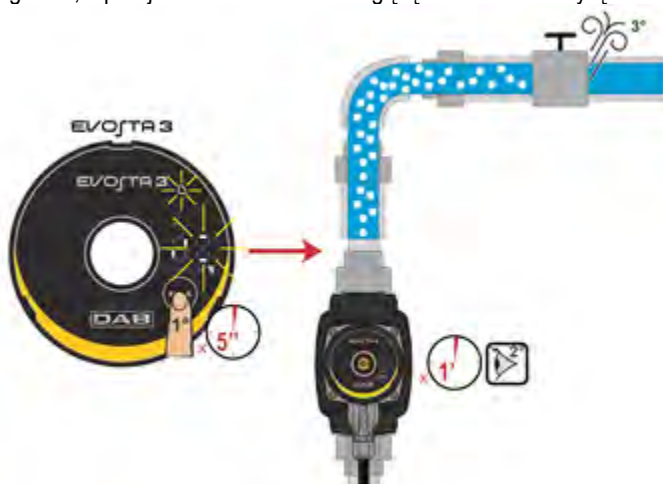
9 pav.: Automatinis oro išleidimas iš siurblio
