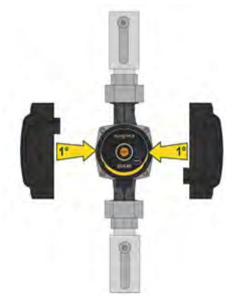
Slika 7: Izolacija ohišja črpalke
