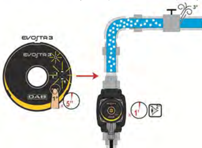
Малюнок 9: Автоматичний випуск газів з насоса
