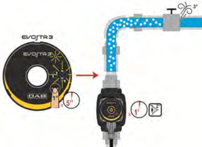
Фигура 9: Автоматично обезвъздушаване на помпата
