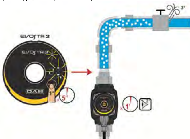
Rysunek 9: Automatyczne odgazowanie pompy
