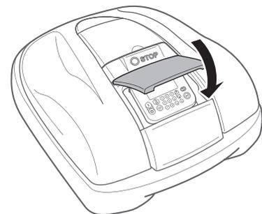
Ahora ya se ha completado el ajuste. El cortacésped comienza el corte a la hora programada del modo de Configuración rápida.
