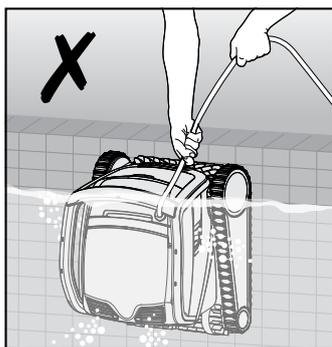
5.7.2 Use el cable flotante para tirar del Limpiafondos Automático hacia la pared de la piscina. Use el asa para retirar el limpiafondos de la piscina.
