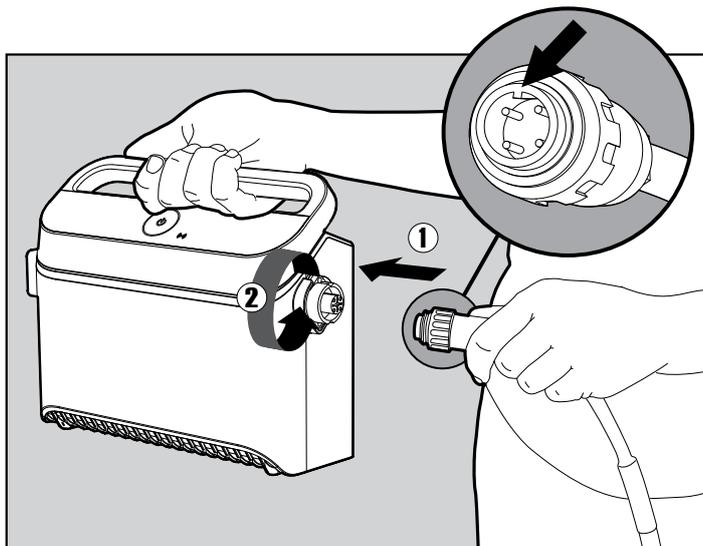
**5.1.3** Conecte el cable flotante a la fuente de alimentación: introduzca el cable con la muesca en el conector (1), alineado con la ranura de la toma de la fuente de alimentación, y gírelo en el sentido de las agujas del reloj (2).
