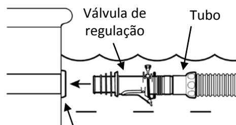
Tomada de aspiração com válvula de segurança (Não incluído com o aparelho de limpeza)
