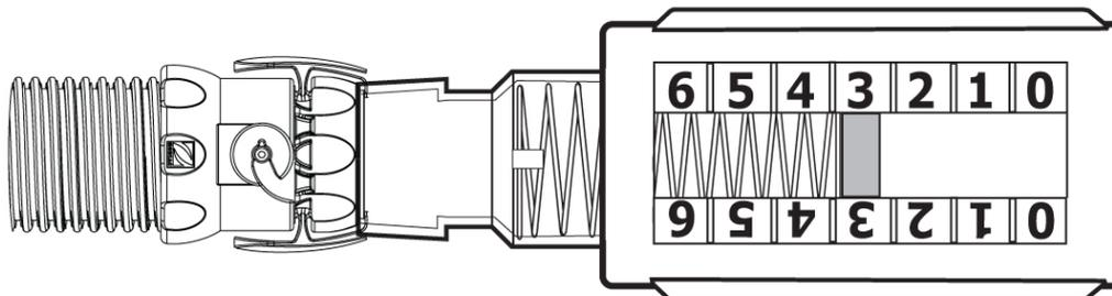
Se for necessário, utilize as válvulas situadas na área técnica da piscina para ajustar o débito para que o indicador fique na posição 3.
