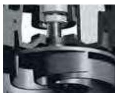
Ampla câmara entre o impulsor e o cone de aspiração que permite a passagem de partículas sólidas em suspensão.
