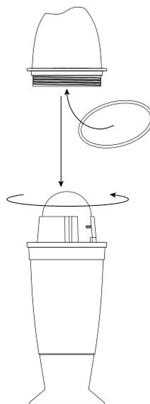
8. Cole a nova fita adesiva que vem com a pilha e volte a colocar a junta. Coloque a tampa e volte a colocar o **Blue Connect** na piscina.
