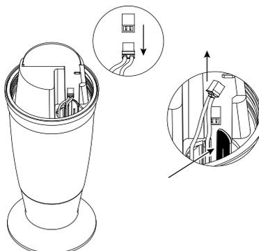
6. Coloque a pilha no fundo da cavidade até a bloquear. Em seguida, ligue o conector.
