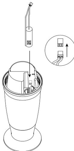
7. Coloque a nova junta que vem com a pilha nas filetas da rosca da parte superior do aparelho. Feche a parte superior. O filete da rosca é à esquerda: deverá assim enroscá-lo em sentido contrário aos ponteiros do relógio.
