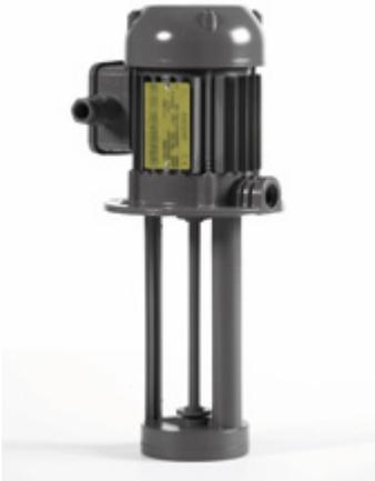
Sono adatte al trasferimento di liquidi contenenti impurità di dimensioni fino a 3 mm. I componenti idraulici: girante, chiocciola e corpo pompa in PBT, ne consentono l'impiego con acqua, emulsioni e sostanze oleose in genere, con viscosità non superiore a 21 cSt (3° Engell). La temperatura del liquido non deve superare i 70°C.
